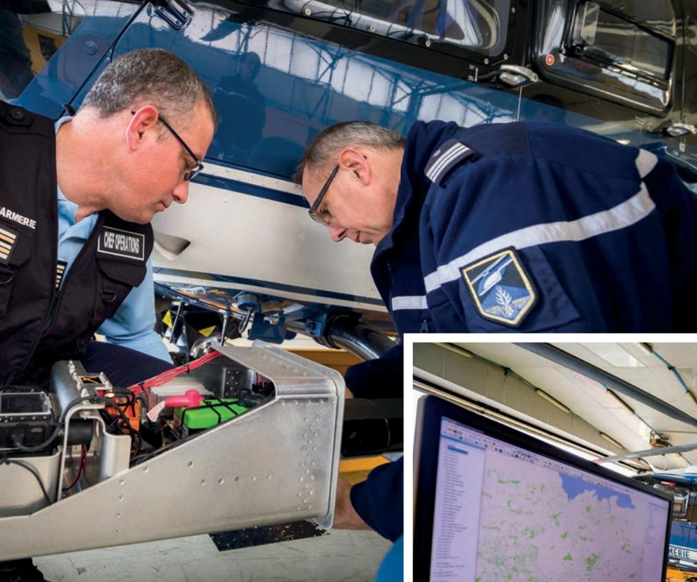
Avant le vol, l'opérateur SC2 et l'équipage de l'hélicoptère font le point sur les conditions aéronautiques. Le logiciel du pod air élabore une stratégie d'acquisition orthophotographique (plan de vol) en fonction des données enregistrées (point d'entrée de la zone à cartographier, altitude de vol, etc.).
